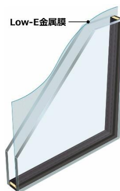
Low-E ガラスイメージ （複層ガラス 断熱タイプ）
