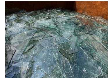
ガラスくずを選別して破砕後、回収したガラスカレット
