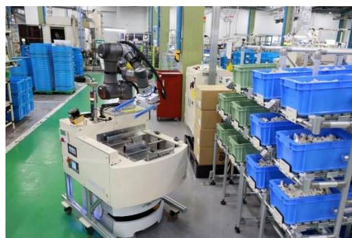
自律走行搬送ロボットが部品を運ぶ様子
