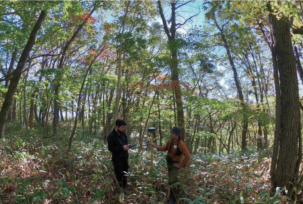
青山友和氏は、VRS/RTKを含めて、GNSS測量のノウハウを積み重ねてきたGNSSのスペシャリストだ。見通しがきかない場所、迂回しなければならない場所、機器が重くて移動が不自由な場所などは、たとえ枝の生い茂ったヤブの中でも、トータルステーションよりGNSSのほうが効率よく測量できると語る。
