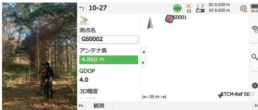
ヤブの中で高いポールを使った計測時の様子(左)と、3次元のフィールド・ソフトウェア「Leica Captivate ソフトウェア」の画面(右)。Captivateの3Dビューワ画面は、地面に置いたポールの先端からアンテナまでの正確な高さや位置と傾きをわかりやすく表示しており、使いやすい
