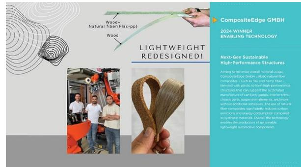
天然繊維複合材料の使用は、合成材料に比べて二酸化炭素排出量とエネルギー消費量を大幅に削減します。全体として、この技術は持続可能な軽量自動車部品の製造を可能にします。
