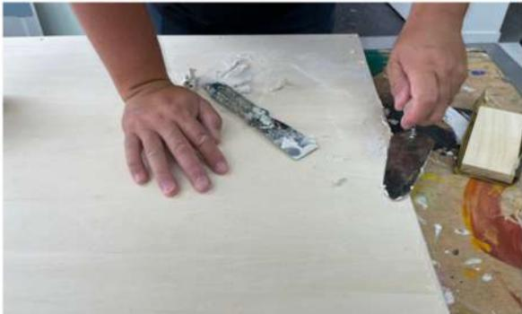
木材を組み立てたビス穴がある場合は、凹みをパテで埋めておきます。パテが乾いたら、サンドペーパーでやすりがけをして表面を平らにします。
