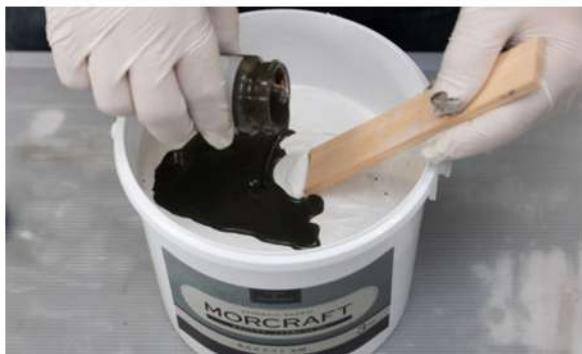
モルクラフト主材の色を混ぜて作成する工程（調色）の説明をします。
