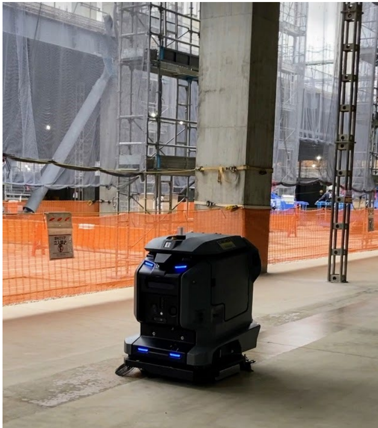
建設現場で稼働する床洗浄ロボット KIRA B 50
