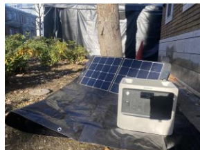
ソーラーパネル(太陽光発電) とポータブル蓄電池 (株式会社JVCケンウッド)
