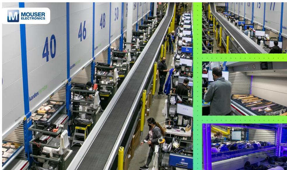
2022年春、マウザーは世界最多の垂直リフトモジュール（VLM）120台を導入する予定です。VLMは、部品を保管する棚と巨大な縦型ファイリングキャビネットを備え、自動エレベーターで部品を従業員のいる作業場に簡単に届けることができます。VLMは作業効率と床面積のスペース効率を向上させ、従業員の移動時間を45%以上短縮可能にしています。
