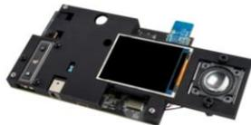
IoTデバイスに顔認識と2Dまたは3Dの活気検出の追加を検討中の開発者にとって、NXP Semiconductors SLN-VIZN3D-IOT開発キットは、家庭、産業、接客の幅広いアプリケーションやアクセス制御製品向けのターンキーオフラインアプリケーションの設計に最適なソリューションです。このキットは、最大1GHzで稼働するNXP i.MX RT117Fクロスオーバープロセッサを搭載し、画像キャプチャ、顔アライメント、顔追跡、顔検出、顔認識、活気検出の機能などの、3D顔認識用のNXPのi.MX RTランタイムライブラリを実行できます。また、SLN-VIZN3D-IOTキットには、エンドユーザーが自分の顔をモバイル端末から登録できるリモート認識機能も搭載されています。
