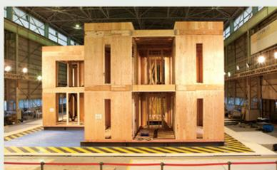
制震効果確認試験(実大振動台実験)@防災科学技術研究所(つくば)
