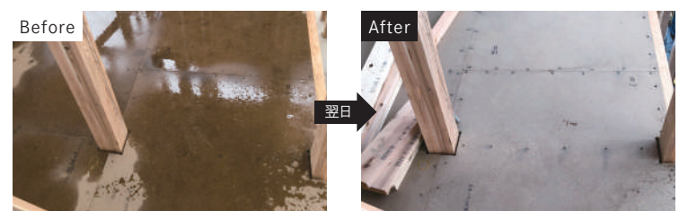
▶試験棟を使った突発の雨掛かりを想定した実験のようす
