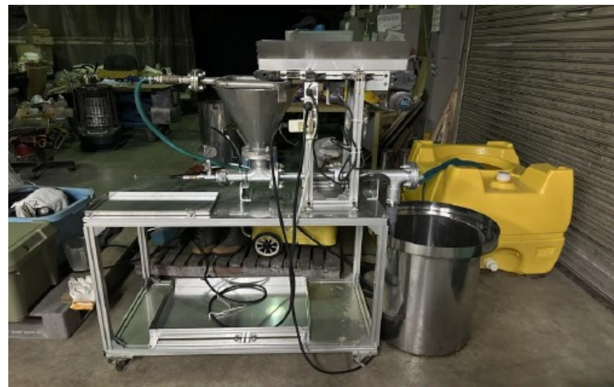
東京電力グループ(JESCO)・三和製作所による高圧エジェクターによる土壤の解砕分級実証試験
