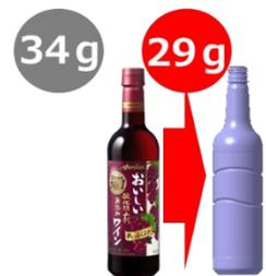
本開発では、ワイン瓶を想起させる「ボルドー肩形状」と「胸部のすっきりとした形状」を両立させながら、従来から樹脂量を約15%削減した720mlペットボトルを新たに設計しました。デザイン性の高いリブを配置することで、ワインの情緒感を表現しながら、軽量化しても持ちやすさを維持した形状です。今回の受賞では、ワインらしいデザインと環境調和性を兼ね備えたメルシャン史上最軽量のペットボトルを開発したことが評価されました。
