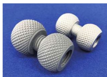
ボルト・ナット(左:造形品 右:焼結品)
