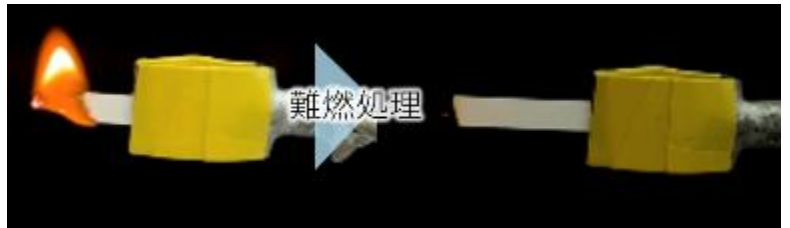
着火後約 10 秒で自己消火した難燃パルプ
