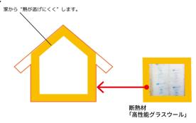
家全体(床・壁・天井)を性能の高い 断熱材に交換することで、室内から 逃げる熱量を抑制し、家中が快適 になります。
