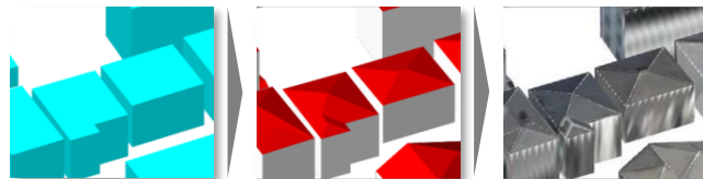
屋根面を推定・モデル化 テクスチャ自動貼り付け
