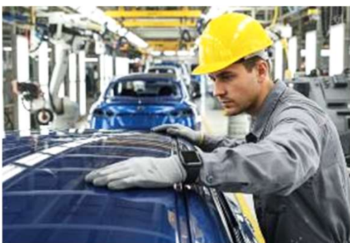
塗装面の凹凸検査
