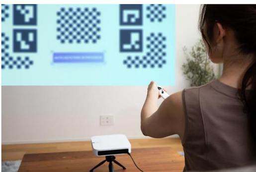
「XGIMI Elfin」には、高速で投影映像のピントを合わせる“オートフォーカス機能”や、斜めからの投影でも上下左右の歪みを補正して、長方形の映像を投影できる“自動台形補正機能”が搭載されています。そのため、プロジェクターを起動してすぐに、綺麗な映像を投影することができます。
