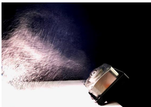
開発した車載用超音波クリーニングレンズユニット(左)と超音波で雨滴霧化している様子(右)
