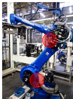
全固体電池を搭載した産業用ロボット (赤丸の位置に全固体電池の電源モジュールを搭載 *1) )
