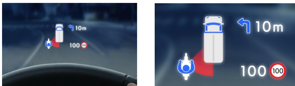
トラックやバス、建設機械向け Head-Up Display の表示イメージ(左)と拡大図(右)
