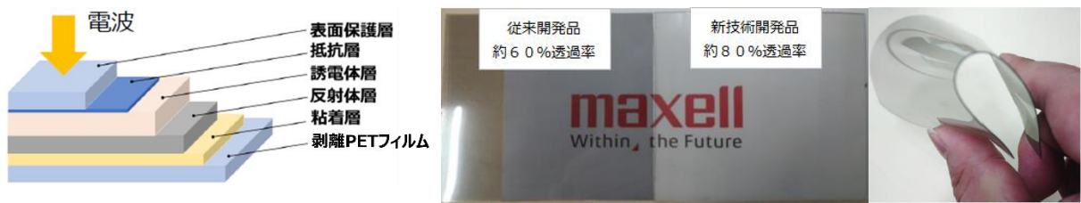
左：テラヘルツ波対応透明電磁波吸収シートの構造、右：透明性とフレキシブル性
