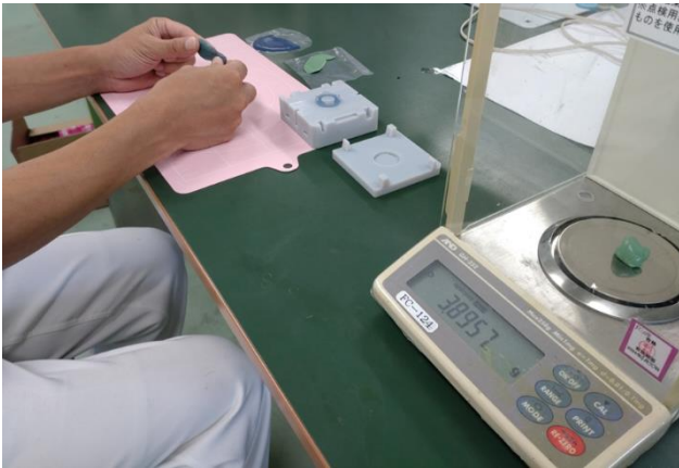
ゴム製造スタッフの仕事 (シリコンゴム材料を使用して混練作業を行った後、簡易金型でゴムの成型を行う)
