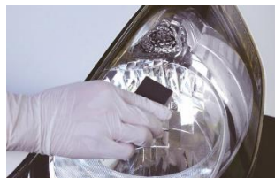
②液を少量ずつスポンジに染み込ませ、薄く塗布
