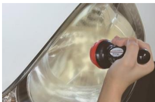
①ヘッドライトを清浄（洗浄・研磨）する
