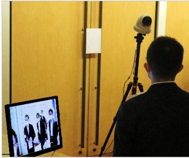
＜サーモカメラによる体温検出の例 左：多人数検出イメージ、右：体温表示画面＞
