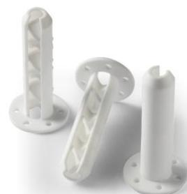
写真：Alumina 4Nレジンのスタティックミキサーサンプル
