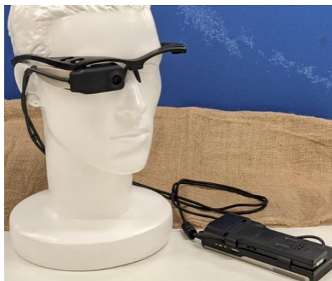
図 アクセサリカメラ RD2CAM と取り付けイメージ図。カメラ映像が網膜に投影されます。
