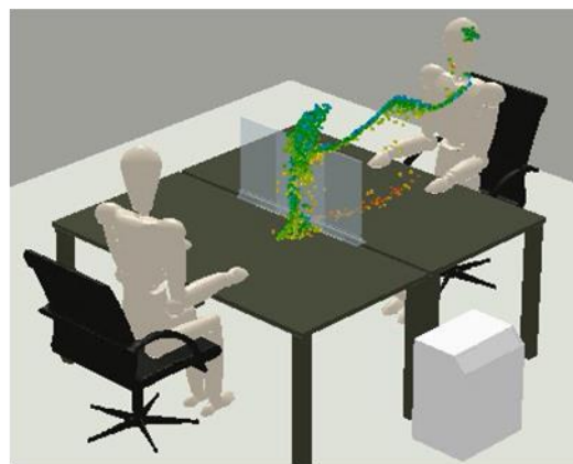
吸引装置連動のパネルが飛沫を吸引
