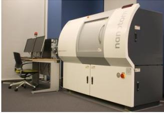
180kv/15W という超高性能ナノフォーカス X 線管、高精度マニピュレーター、そして先進のソフトウェアモジュールをそなえ、あらゆる 3D 高解像度 CT 撮影に適しています。
