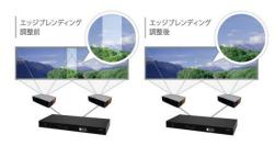
複数のプロジェクターが投写して重なるエリア (オーバーラップエリア)の光量を水平・垂直方向 に調整し、継ぎ目のないマルチプロジェクションを 実現します。
