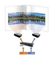
コーナーのある 壁面 (90° コーナー、 正面 & 床面などの 2 面) に対して、プロ ジェクター1 台で投 写を実現します。
