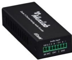
Dante 非対応のアナログオーディオ機器を Dante 対応オーディオ機器に接続できるオーディオエンコーダーです。フルレンジ (20Hz ~ 20kHz) のバランスまたはアンバランスの 2 チャンネルアナログオーディオ信号をネットワーク経由で Dante 機器に送信できます。PoE または DC12V により稼働します。
