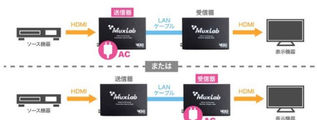
PoC (Power・Over・Cable) 機能により、AC アダプターを送信器または受信器のいずれか一方に取付けると、残りのもう一方へは LAN ケーブルを通じて電源供給できます。
