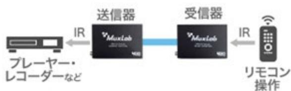
HDMI 信号と同時に IR 信号 (片方向) も延長できます。受信器を設置した場所から、バックヤードに設置したソース機器のリモコン操作が可能です。
