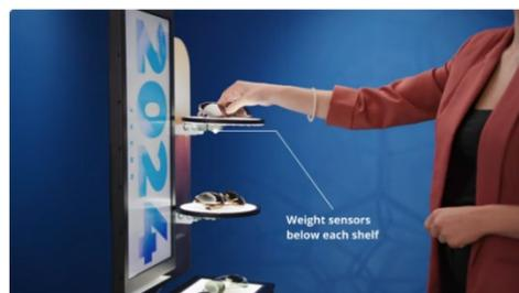
当製品は、センサー、コントローラー、ケーブルがセットになったキット製品です。1つのコントローラーに最大8つのウェイトセンサーを接続でき、追加用センサーはオプション品としてご購入いただけます。トリガー設定は「BrightSign」のオーサリングソフトウェア「BrightAuthor」を使用して簡単に行えます。
