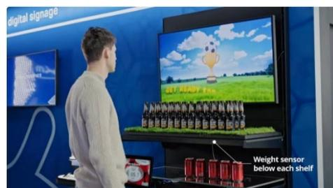
当製品もセンサー、コントローラー、ケーブルがセットになったキット商品です。1つのコントローラーに最大 8 つのウェイトセンサーを接続できます。追加センサーはオプション品です。トリガー設定はオーサリングソフトウェア「BrightAuthor」で簡単に行えます。
