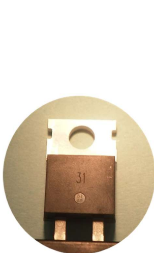
図1 試作したSBD（JBS構造）のサンプル（TO220パッケージ）
