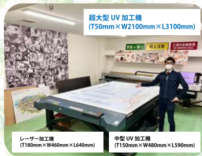
超大型 UV 加工機 (T750mm×W2100mm×L3100mm) レーザー加工機 (T180mm×W460mm×L640mm) 中型 UV 加工機 (T150mm×W480mm×L590mm)
