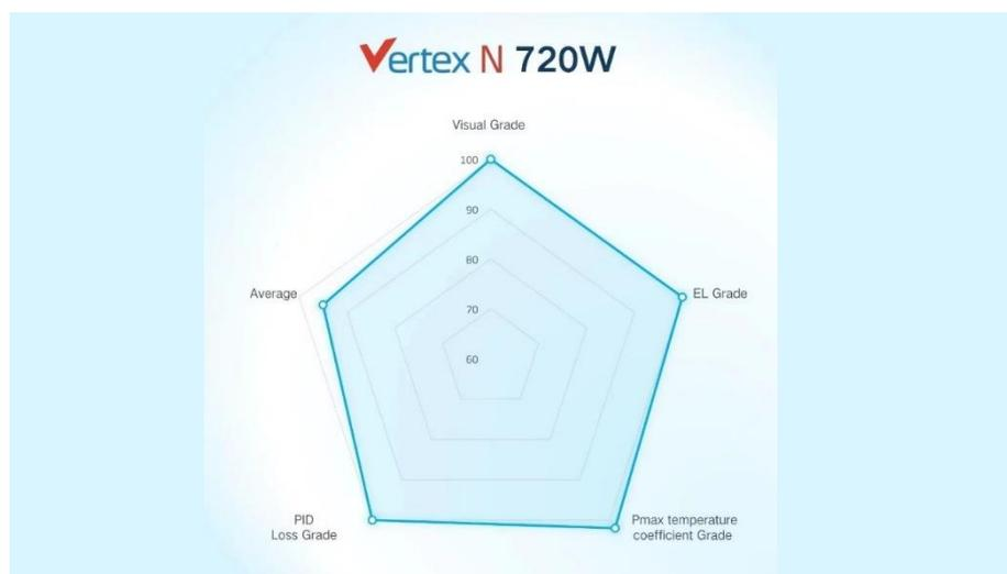
屋内試験は、目視検査、EL、低照度性能、温度係数、PID の 5 つの必須項目と LID の任意項目で構成されています。トリナ・ソーラーの Vertex N 720W モデル(NEG21C.20)と Vertex S+スケルトンモデル(NEG9RC.27)は、必須評価項目でそれぞれ平均 95 点と 92 点を獲得し、卓越した性能を示しました。
