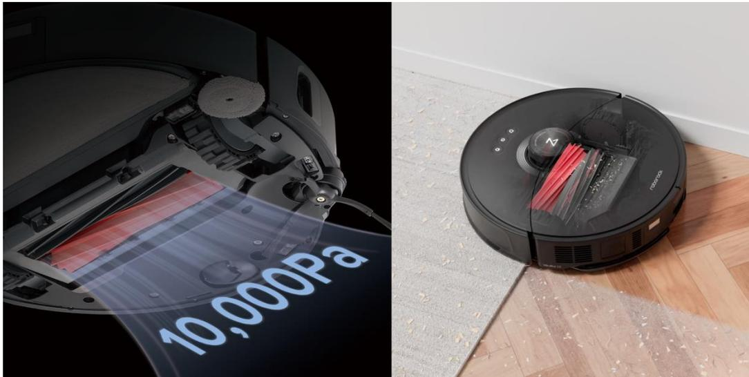
水拭き性能は、最大毎分 4,000 回にパワーアップしたモップの高速振動と高加重モップで、皮脂やコーヒー、花粉、乾いてこびり付いた頑固な汚れもキレイに拭き上げます。また、水拭き掃除中に超音波センサーがカーペットを検知すると、水拭きモップと壁キワ用モップが自動で 20mm 持ち上がり、吸引掃除のみを行います\*4。稼働音や二次汚染を防ぐため、水拭きのみの掃除やドックに戻る際には、メインブラシが自動で持ち上がります。
