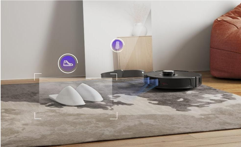
また、毎分 300 回転する高精度レーザーセンサーが部屋を掃除しながら 360 度スキャンすることで、部屋を素早くマッピングし、独自のアルゴリズムとともに効率的なルートで掃除を行います。さまざまなセンサーが連携し、家具や障害物を検知することで、段差からの落下や家具への挟まりを回避しながら部屋の中を隅々までスムーズに移動することができます。
