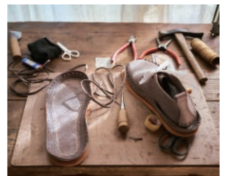
上部と下部を結びつける紐は、本体と同じレザーから自ら切り出したものを使用。丁寧に編み合わせていく
