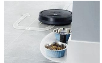
直径約 120cm の侵入禁止エリアを作る ヘイローモード ※イメージ
