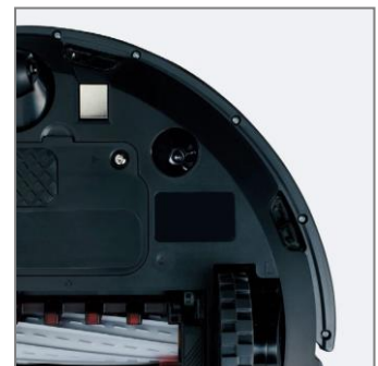
本体裏面 フロアトラッキングセンサー装備
