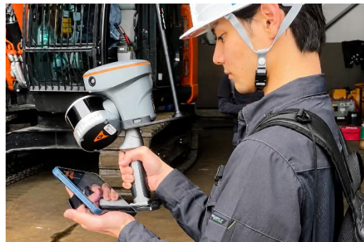
3D ハンディスキャナを用いた測量の様子
