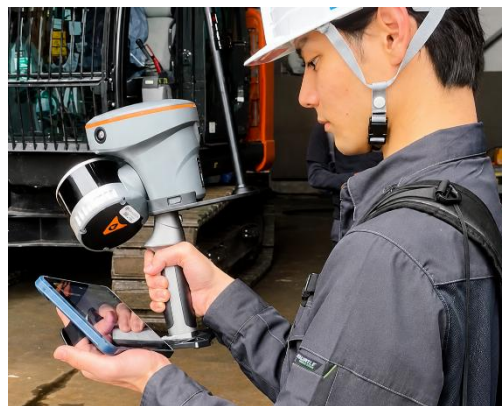
3D ハンディスキャナを用いた測量の様子
