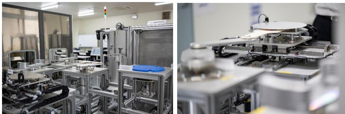
当社は様々な製造工程へスタッフを配属するため、製造工程設備毎（メーカー・機種毎）にウエハの載置場所や装置操作が異なるティーチング作業の研修において、これまでは、配属する工程ごとに就業先と同等の研修装置を準備することが困難でした。そこで、複数工程のティーチング作業訓練を行う研修機材を導入できないかと考え、定期メンテナンス作業の研修に使用しているチャンバを製作する際に、余剰となったウエハ搬送ロボットを活かし、不足部品を自作することで、独自の半導体搬送演習装置の開発を実現いたしました。
