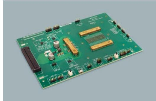
**Vicor の 1200A の LPD (水平方向からの給電)ソリューション。1つの MCM ドライバ「MCD4609」と2つのカレントマルチプライヤ「MCM4609」で構成**
