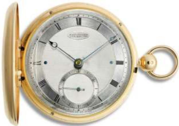
シンプル トゥールビヨン クロノメーター (ギャルド・タン)、ゴールド製手彫りギヨシェ模様のハンターケース、クリスタルのキューベット、シルバーダイヤル、ローマ数字、6時位置にスモールセコンドサブダイヤル、1分間に1回転するトゥールビヨン・レギュレーター、レバー脱進機、バイメタル・テンプ、ブレゲひげゼンマイ。ケース径：61 mm
