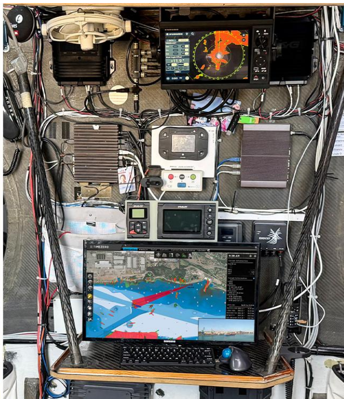
MILAI22 のコックピットに装備される、マルチファンクションディスプレイ「NavNet TZtouchXL(ナビネット・ティーゼットタッチ・エックスエル)」を含む各種航海用電子機器
