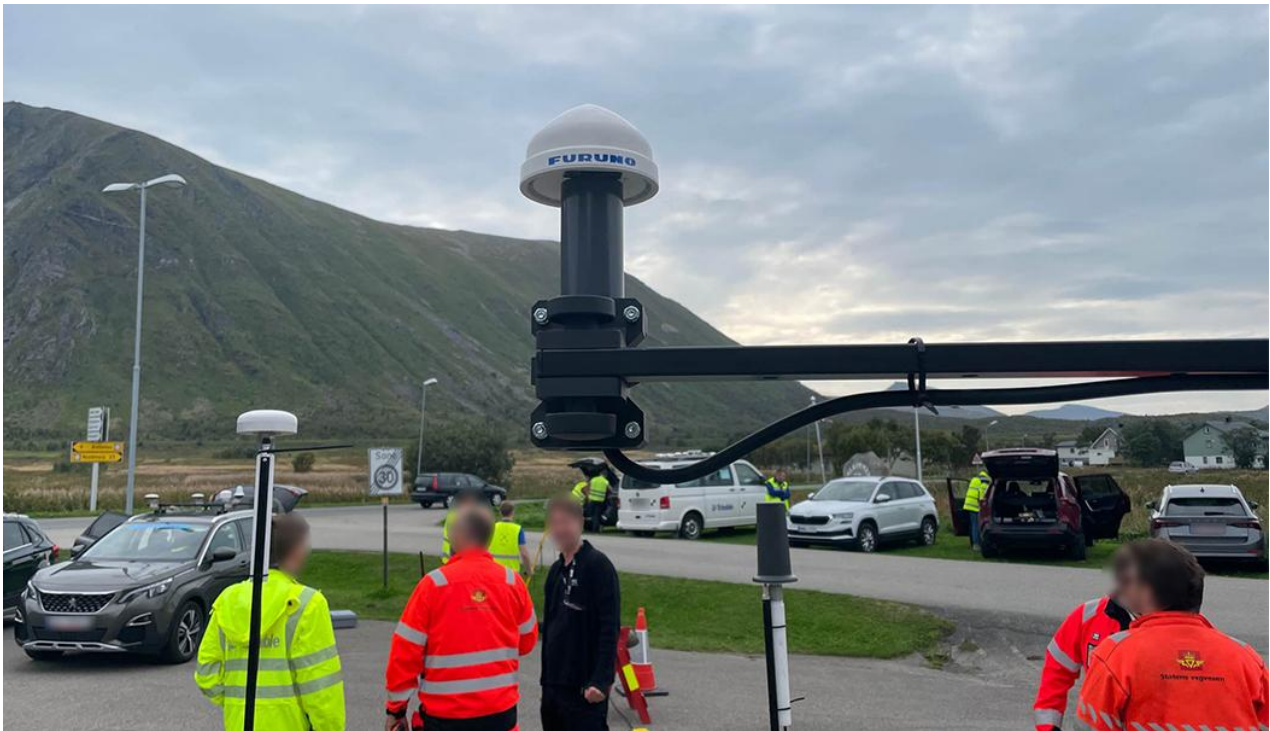
実環境下でのGNSS耐性試験の様子
