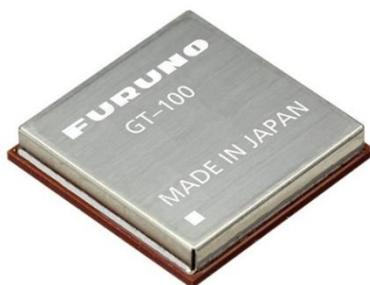
L1・L5の2周波受信により、世界最高水準の時刻精度（4.5ns未満/1σ）と高い堅牢性を両立した時刻同期用GNSS受信モジュール
