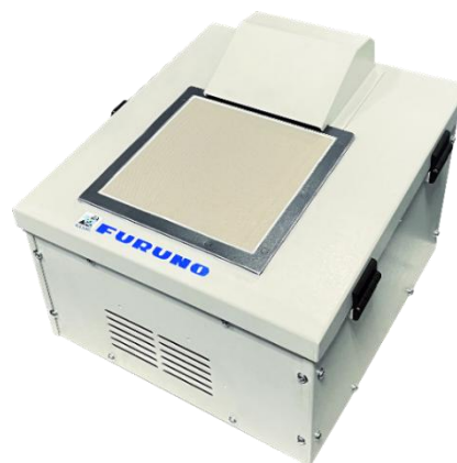
水蒸気マイクロ波放射計「KASMI-160」
