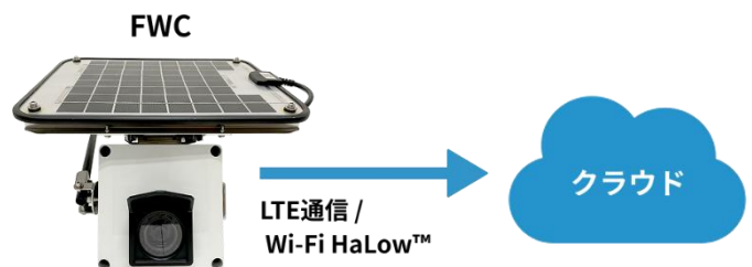
LTE 通信／Wi-Fi HaLow™ (IEEE 802.11ah)によるクラウドを使用した遠隔監視
